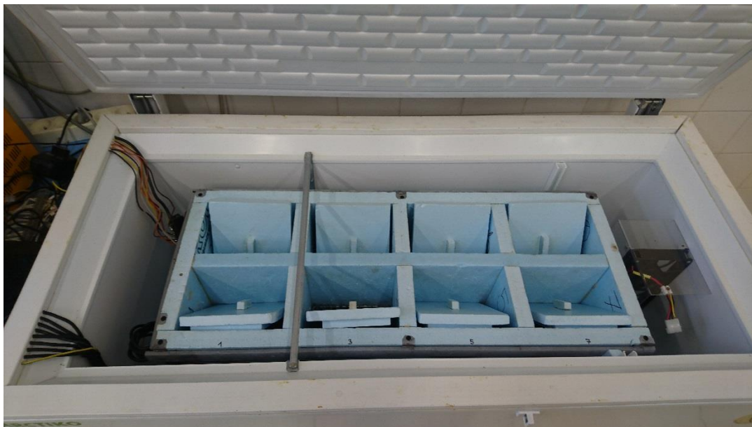
Obr. 3 Laboratorně upravený programově řízený mrazicí box pro regulované snižování teploty.
