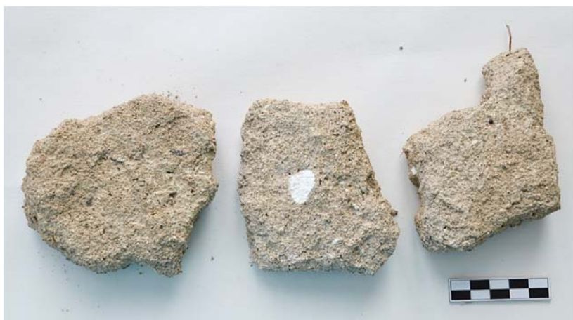
Obr. 1. Vzorky barokní omítky z jižní fasády Staré prelatury klášteře v Kladrubech před zpevněním.
