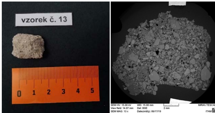
Obr. 7 Analyzovaný vzorek omítky - vlevo makrosnímek, vpravo snímek z elektronového mikroskopu (SEM)
