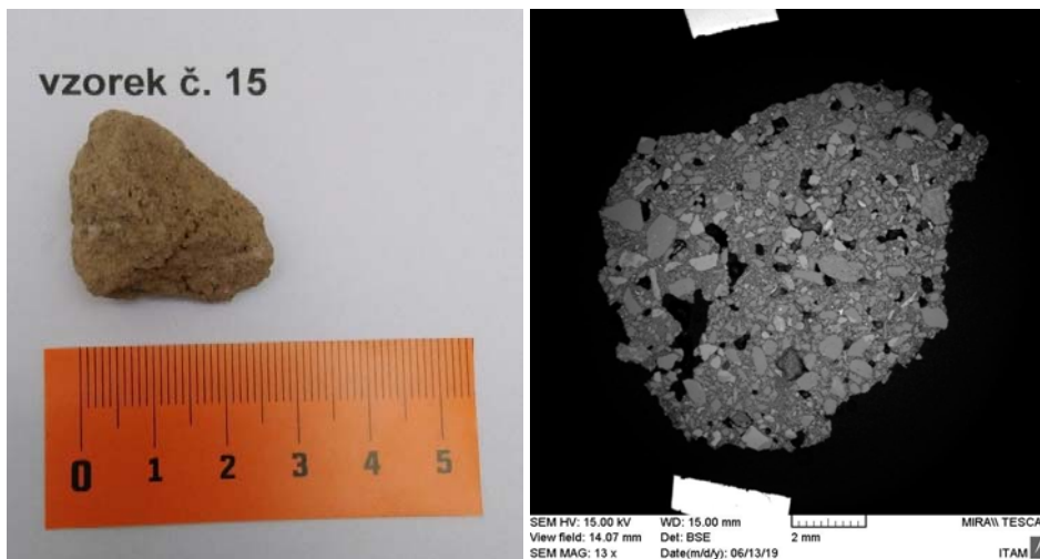
Obr. 10 Analyzovaný vzorek hliněné hrudky - vlevo makrosnímek, vpravo snímek z elektronového mikroskopu (SEM).
