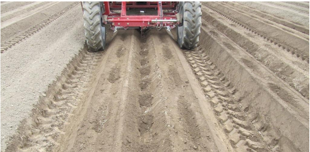
Obr. 8: Vytváření přerušovaných žlábků na povrchu hrůbků a důlek v nekolejové brázdě při sázení brambor
