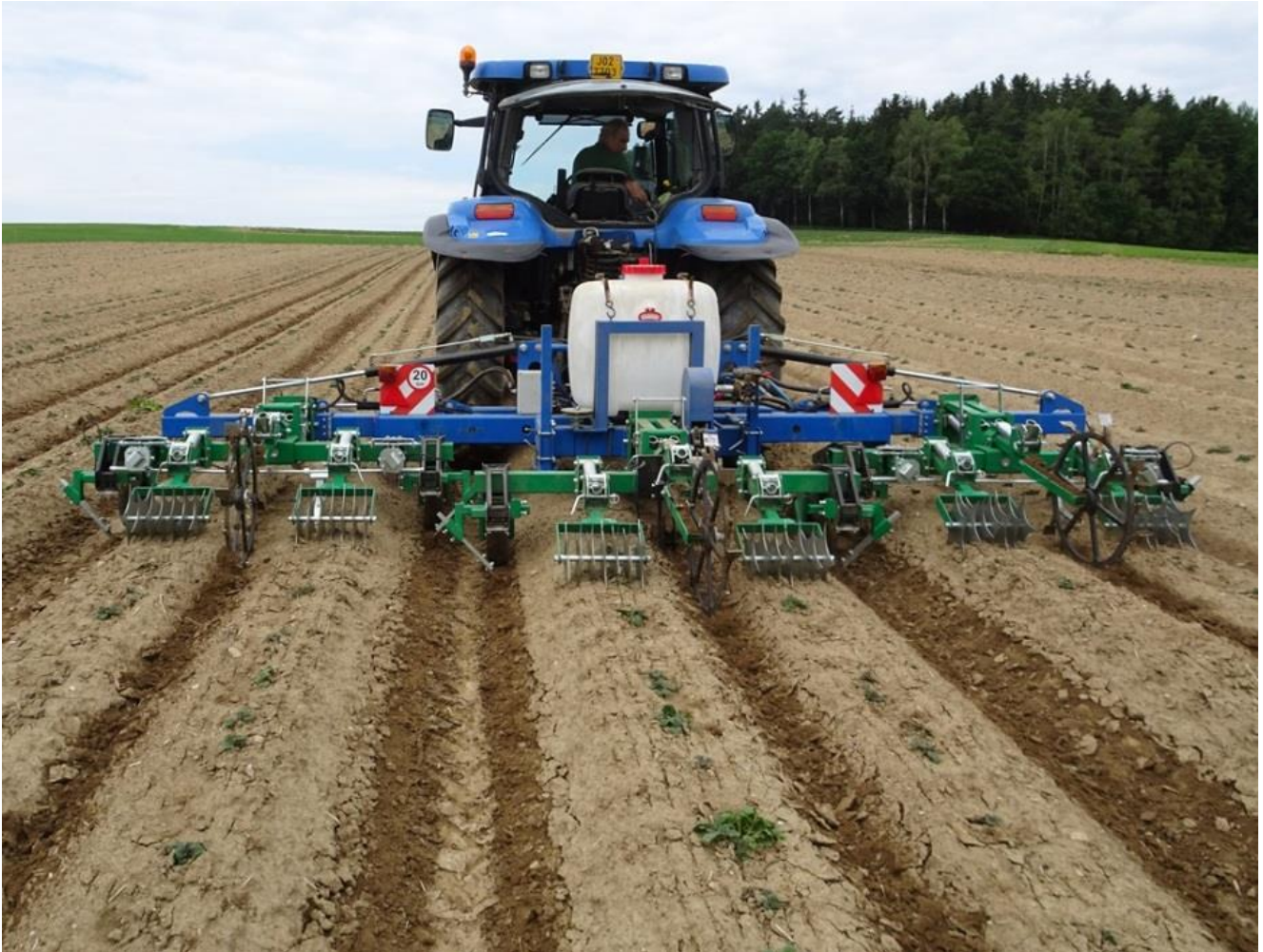
Obr. 9: Kypřič hrůbku brambor s přihnojením na začátku vzházení
