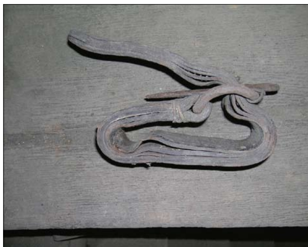
Poděbrady, okr. Nymburk. Původní řemen srdce zvonu z r. 1759 s volnou jehlicí (foto P. Vácha, 2007).
