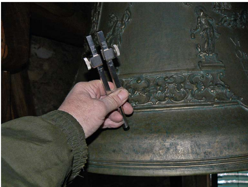
Obr. 7: Ladička přiložená na zvon (určení primy).
