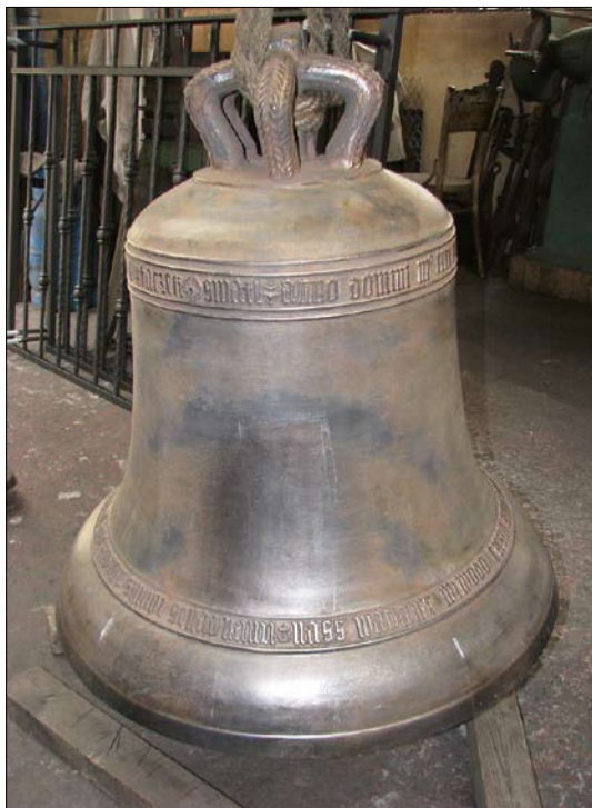
Košic, okr. Kutná Hora. Zvon z r. 1475, restaurovaný na přelomu roků 2010 a 2011. Puklina byla svařena, nápis v místě opravy obnoven, vytlučení ořence navařeno. Od r. 2012 opět vyzvání (foto P. Vácha, 2011).
