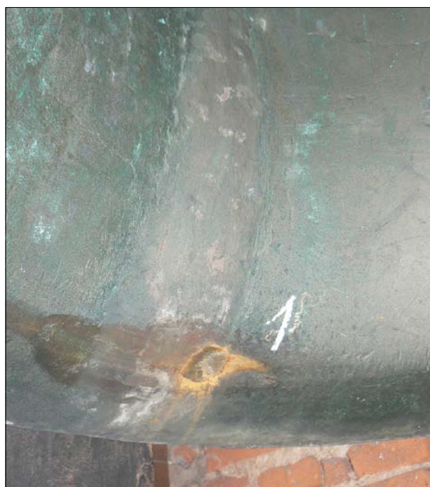
Lažánky, okr. Brno-venkov, zvon z r. 1534. Puklina opravená svařením v polovině 20. století. (Foto P. Vácha, 2015).
