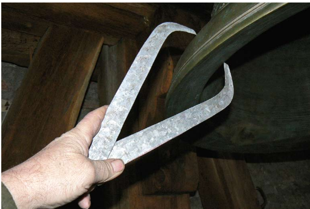
Obr. 3: Měření tloušťky věnce. Rozměr přeneseme a odečteme.
