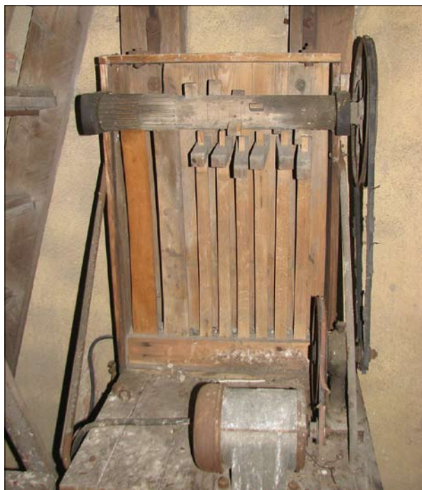
Šarátice, okr. Vyškov. Kombinovaná velikonoční klapačka a řehačka s motorovým pohonem (foto P. Vácha, 2012).
