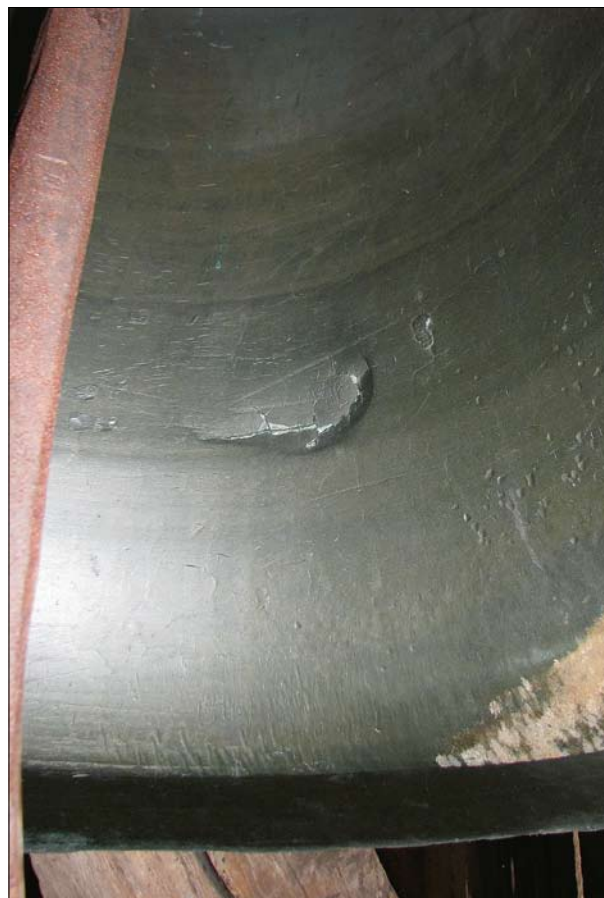
Březina u Mnichova Hradiště, okr. Mladá Boleslav, zvon z r. 1607 od Jakuba Mělnického. Zálupce začišťované dlátem a zbytky hlíny z formy (foto P. Vácha, 2011).
