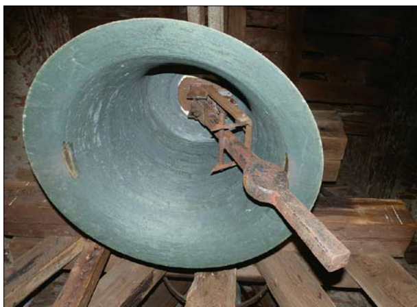
Domašín, okr. Benešov. Vnitřní elektromagnetický zachycovač. Srdce je zachytáváno zoubky, které se zachytí za přivařenou příčku (foto P. Vácha, 2016).
