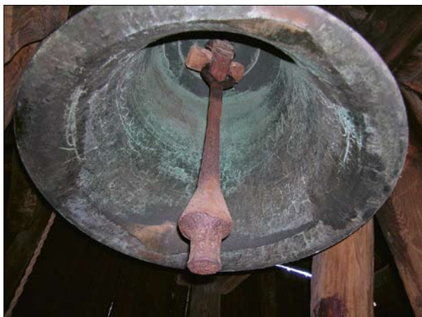
Malín, okr. Kutná Hora, zvonice u kostela sv. Štěpána, zvon z r. 1502. Špalík vsazený do řemenu srdce, aby srdce chodilo v rovině (foto P. Vácha, 2010).
