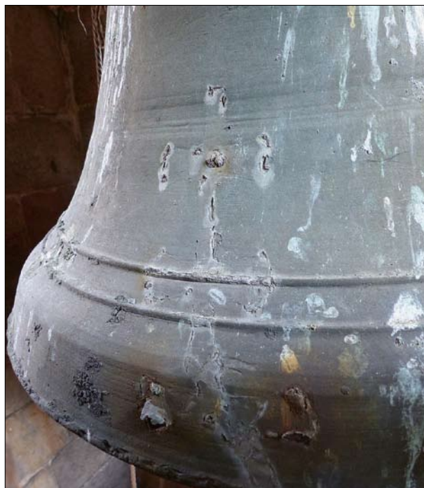
Mohelnice, okr. Mladá Boleslav. Historická oprava puklého zvonu (pravděpodobně v 19. stol.). Propilovaná puklina byla stažena zasekanými železnými motýlovitými sponami (zvenčí třemi, zevnitř dvěma) a zalita olovem. Zvon byl uveden do funkčního stavu, objevila se ale puklina na i protější straně (foto P. Vácha, 2016).
