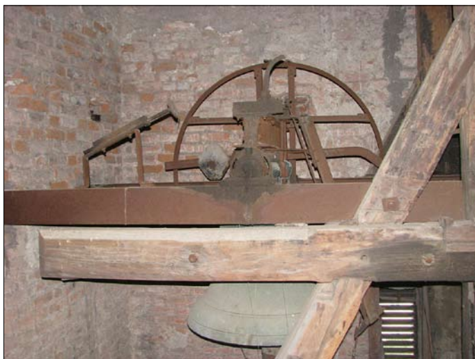
Ivančice, okr. Brno-venkov, kostel Nanebevzetí P. Marie. Vnější mechanický zachycovač srdce. Zub zachytávající třmen, připevněný na srdci, je uvolňován táhlem, které je spojeno s pákou na horní straně hlavy (nad čepem), páka stlačována dopadem na odpruženou záchytku. Tím je zub uvolněn a srdce není při dopadu na věnec zadrženo. Kyo je ovládán spínačem z převodovaným lankem (na opačné straně než hnací kolo) (foto P. Vácha, 2013).
