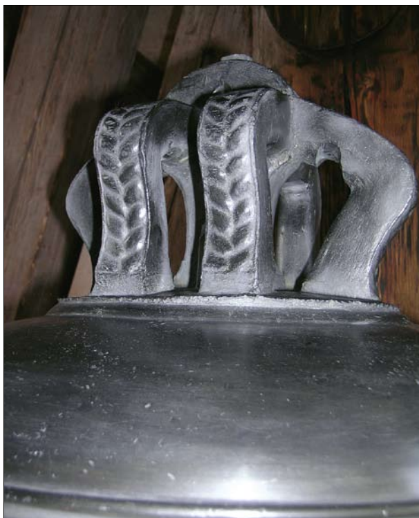
Bystře u Poličky, okr. Svitavy, zvon z r. 1520. Dlouhodobým uvolněním zvonu v závěsu způsobené oymačkání uch koruny (foto P. Vácha, 2007).
