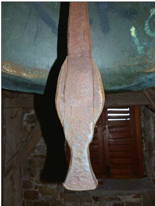
Úžice, okr. Kutná Hora. Oprava otlučené pěstí srdce nakováním materiálu (foto P. Vácha, 2016).
