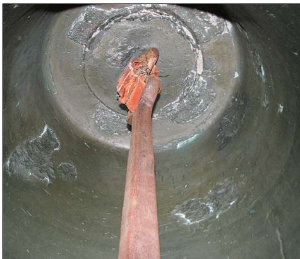
Březina u Mnichova Hradiště, okr. Mladá Boleslav, zvon z r. 1607 od Jakuba Mělnického. Zálupce začišťované dlátem a zbytky hlíny z formy (foto P. Vácha, 2011).
