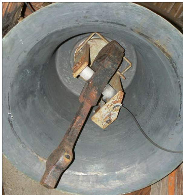
Kamberk, okr. Benešov. Vnitřní elektromagnetický zachycovač srdce. Překlápěcí srdce je zachycováno západkou na horní straně protizávaží (foto P. Vácha, 2015).
