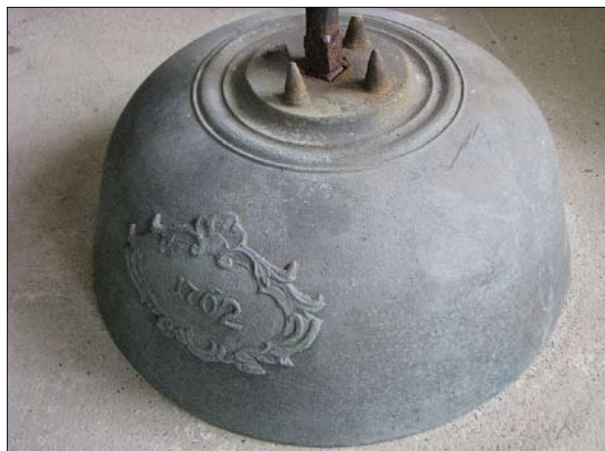
Veltrusy, okr. Mělník, zámek. Hodinový cimbál mísovité z r. 1762 s trny bránícími protáčení po zavěšení (jeden odlomen). Je upevněn železným čepem prolečeným skrz základnu (foto P. Vácha, 2013).
