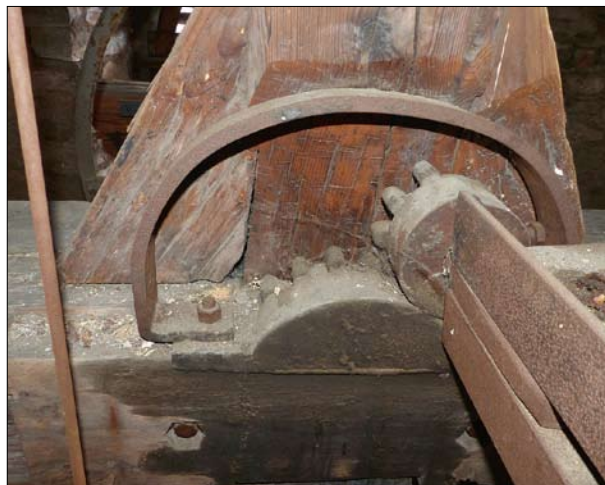
Votice, okr. Benešov, kostel sv. Václava. Ozubené čepy na převalovacích ložiskách, jištěných železnými oblouky, řešení z r. 1929 (foto P. Vácha, 2015).
