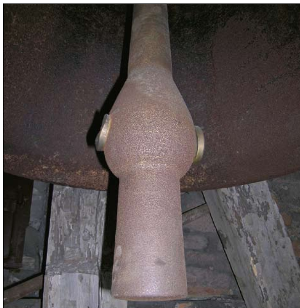
Zlín. Srdce ocelového zvonu z r. 1920 s vsazenými bronzovými úderníky (foto P. Vácha, 2006).
