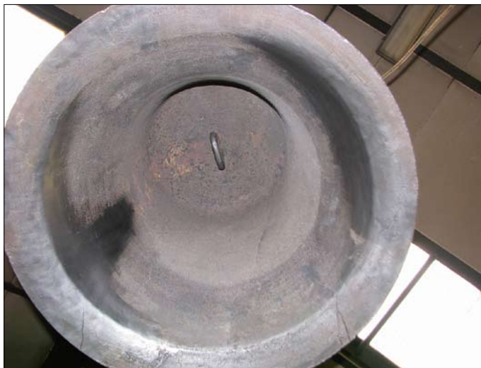
Košic, okr. Kutná Hora. Zvon z r. 1475, restaurovaný na přelomu roků 2010 a 2011. Puklina byla svařena, nápis v místě opravy obnoven, vytlučení ořence navařeno. Od r. 2012 opět vyzvání (foto P. Vácha, 2011).
