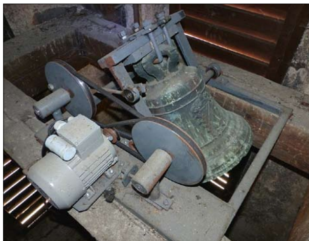
Kácov, okr. Kutná Hora, Příbram, hřbitovní kaple. Elektropohon zvonů zavěšených na lomených hřidelích, pohon ojnicí s převodem přes 2 kola na pomalý chod (foto P. Vácha, 2011 a 2015).
