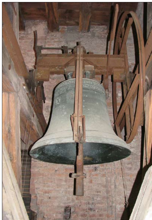
Ivančice, okr. Brno-venkov, kostel Nanebevzetí P. Marie. Vnější mechanický zachycovač srdce. Zub zachytávající třmen, připevněný na srdci, je uvolňován táhlem, které je spojeno s pákou na horní straně hlavy (nad čepem), páka stlačována dopadem na odpruženou záchytku. Tím je zub uvolněn a srdce není při dopadu na věnec zadrženo. Kyo je ovládán spínačem z převodovaným lankem (na opačné straně než hnací kolo) (foto P. Vácha, 2013).
