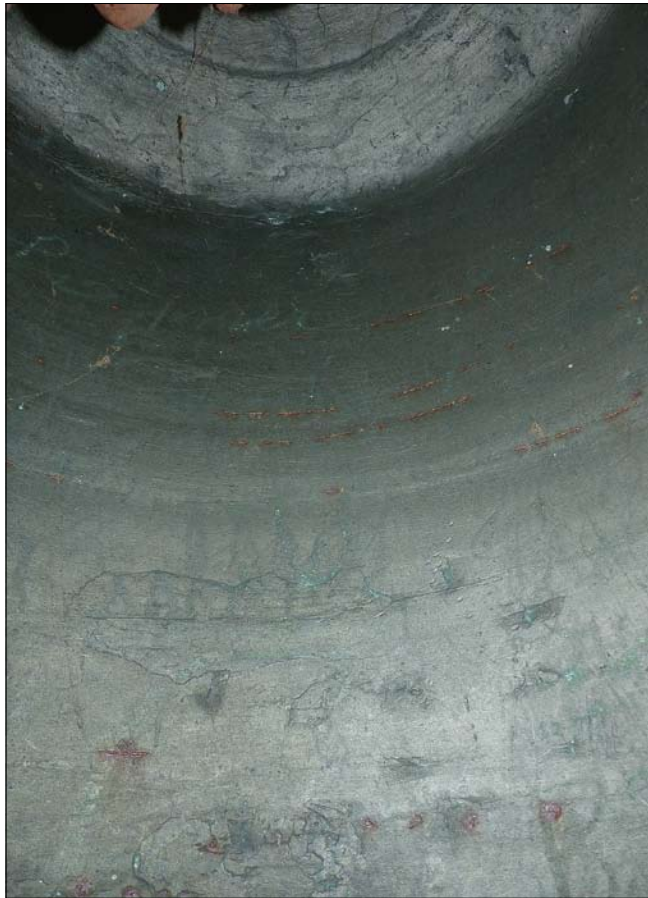
Poříčí nad Sázavou, okr. Benešov, kostel sv. Petra, zvon z r. 1507. Zalitý drát, kterým bylo zpevněno jádro formy (foto P. Vácha, 2015).
