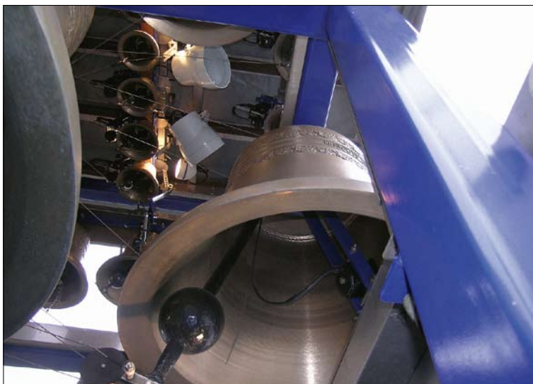
Pražská mobilní zvonohra. Uunitř dolního zvonu je patrné doladování zvonu soustružením. Kromě toho vidíme jednu ze svislých drážek, které zkracují v tomto případě nechtěně dlouhé vyznívání (foto P. Vácha, 2007).
