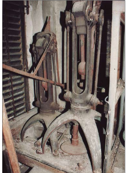
Libice nad Cidlinou, okr. Nymburk, evangelický kostel. Zvon z r. 1895 od Carla Schwabe, původní stav. Litinové stojany Patent Schwabe. (Foto P. Vácha, 1978 a 2003.)
