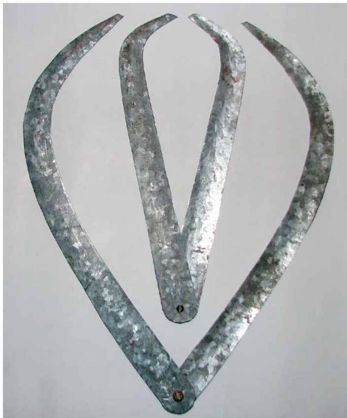
Obr. 2: Obkročná měřidla vlastní výroby pro měření tloušťky věnce pro běžné a velké vozy. Čelisti jsou zhotoveny z pozinkovaného plechu a jsou mírně profilovány, aby držely tvar. Spojení je provedeno šroubkem s maticí, mezi čelisti jsou uloženy podložky.
