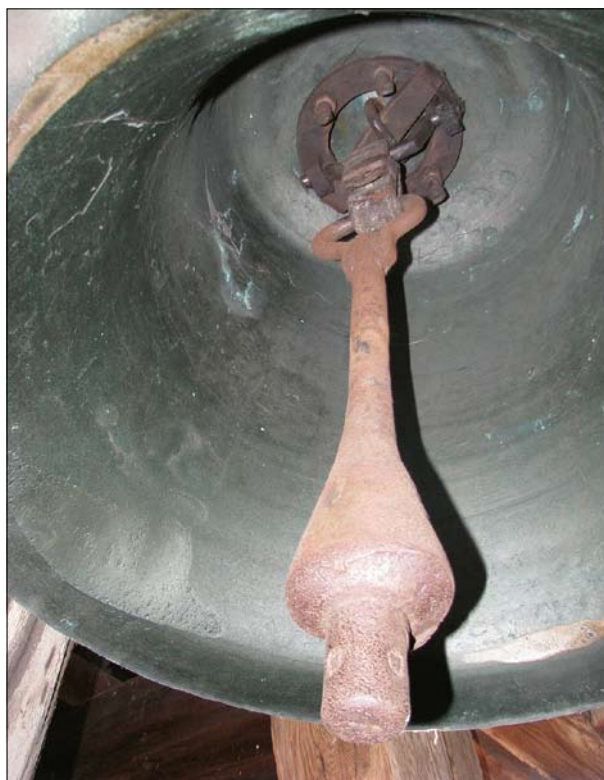
Jabkenice, okr. Mladá Boleslav, zvon z r. 1502. Srdce s přivařeným novým okem, zavěšené na šarnýru po otočení zvonu (foto P. Vácha, 2009).
