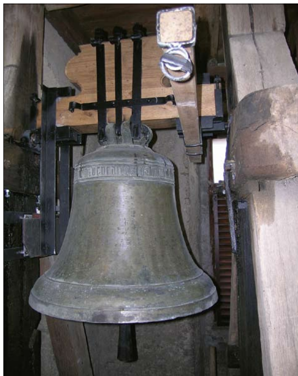
Letonice, okr. Vyškov. Pohon lineárním motorem s možností přechodu k ručnímu zvonění. Nová hlava je tvarovou kopií hlavy starší (foto P. Vácha, 2004).
