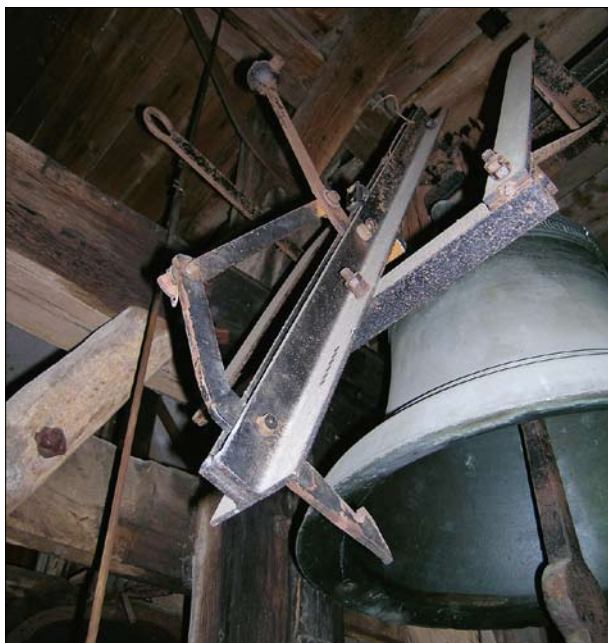
Divišov, okr. Benešov. Vnější mechanický zachycovač srdce. Zub zachycující srdce za třmen připevněný k výpustce je ovládán překlápěcím závažím (foto P. Vácha, 2005).
