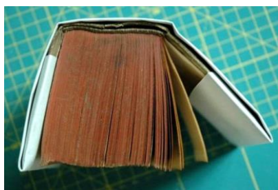
Obr. 41 Výroba konzervační obálky (a) Vsunutí knižní desky do přední záložky obálky. (b) Postupné rýhování a skládání papírové obálky okolo knihy. (c) Zadní deska knihy je vsunuta do zadní záložky obálky. (Záložky obálky jsou založeny nejméně do poloviny, lépe až 2/3 šířky knižní desky tak, aby nedocházelo při otevírání knižní desky k samovolnému vysunutí obálky).
