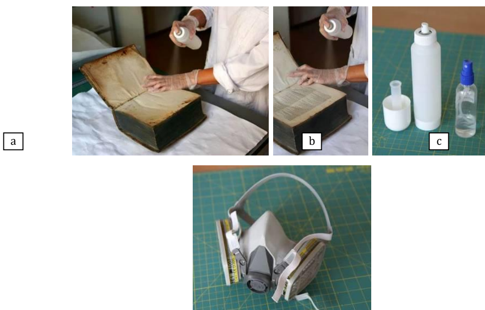
Obr. 6 (a) Nástřik devitalizačního etanolvodného 75% roztoku na listy knihy. (b) Mechanické rozprašovače. (c) Respirační polomaska proti výparům alkoholu.
