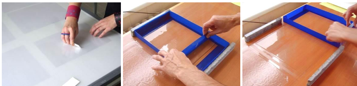
Obr. 46 Vypnutí plastové podložky Durofol. 16 Nanesení lepidla pomocí plastového rámečku.
