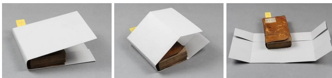
Obr. 43 Vměření šíře hřbetu a předních hran a jejich narýhování.
