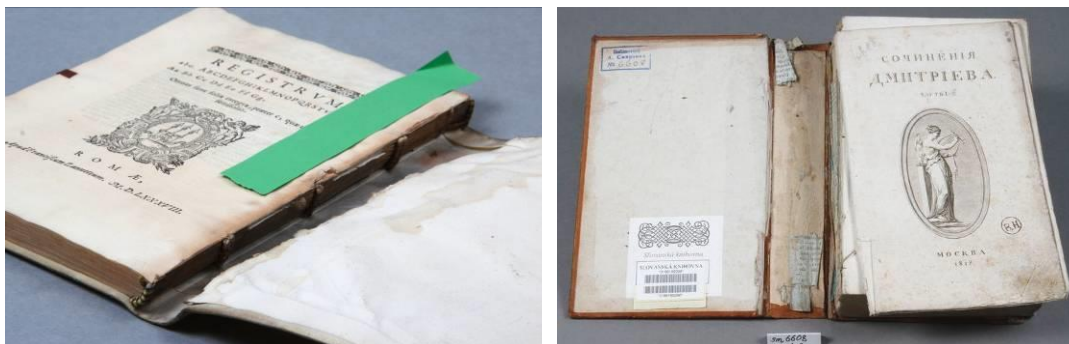
Obr. 9 Prasklé vnitřní drážky. Vlevo pergamenová vazba ze 16. stol., vpravo usňová vazba z 19. stol.
