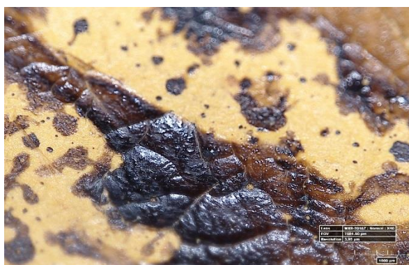
Krakely v lakovaném povrchu potahového papíru, mikrofotografie HIROX
