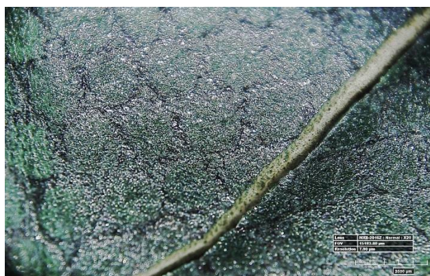
Prasklina v usni, mikrofotografie HIROX
