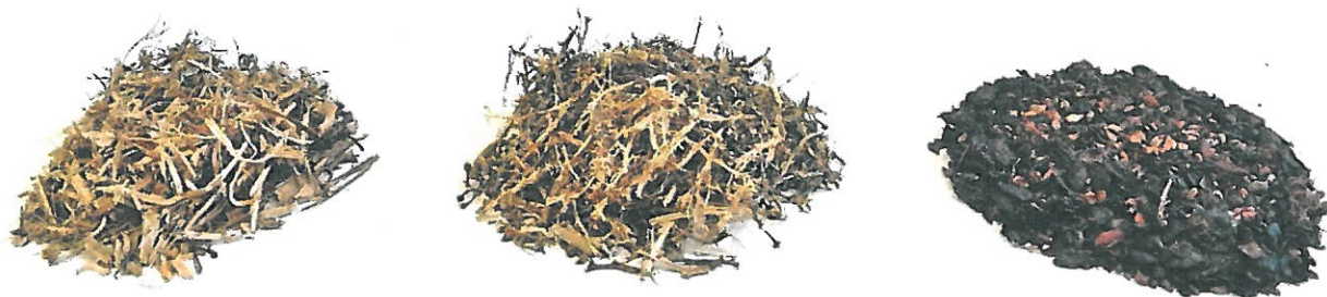
Obr. 1. Odpadní suroviny z vinařství: zleva réví, třapiny a matolina. (Zdroj M. Topiař)
