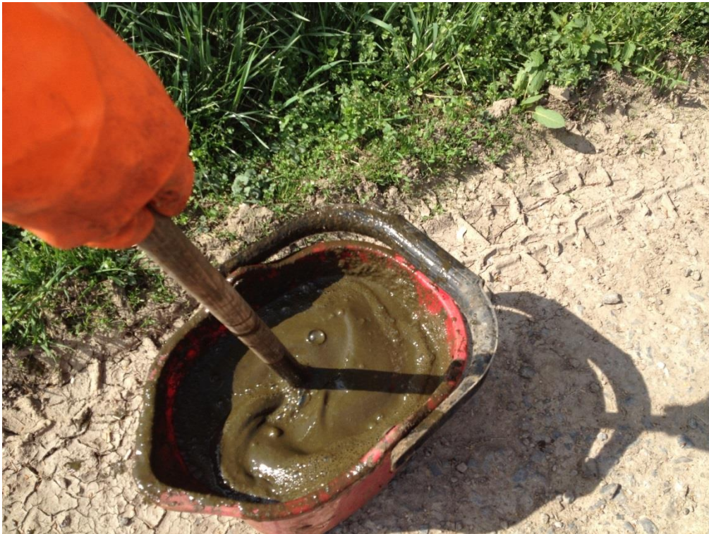
Obr. 2. Příprava směšného vzorku promísením dílčích vzorků tekutých statkových hnojiv /kejda skotu/ (foto J. Dostál).
