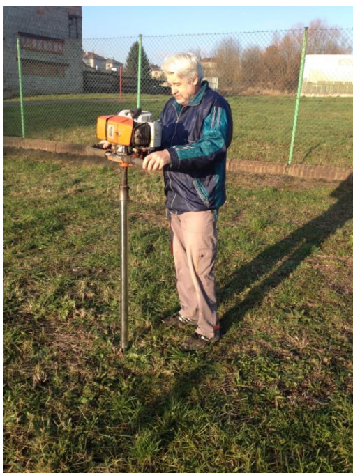
Obr. 4. Příprava odběrového zařízení pro vzorky píce ze skladů siláže a tuhých statkových a organických hnojiv z krechtů - sondovací fréza (foto J. Dostál).
