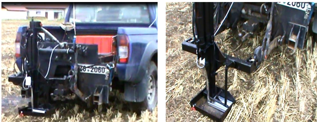
Obr. 5. Navržený prototyp zařízení pro vzorkování půd hydraulicky ovládanou vzorkovací tyčí na motorovém vozidle (foto autor prototypu J. Maňásek).
