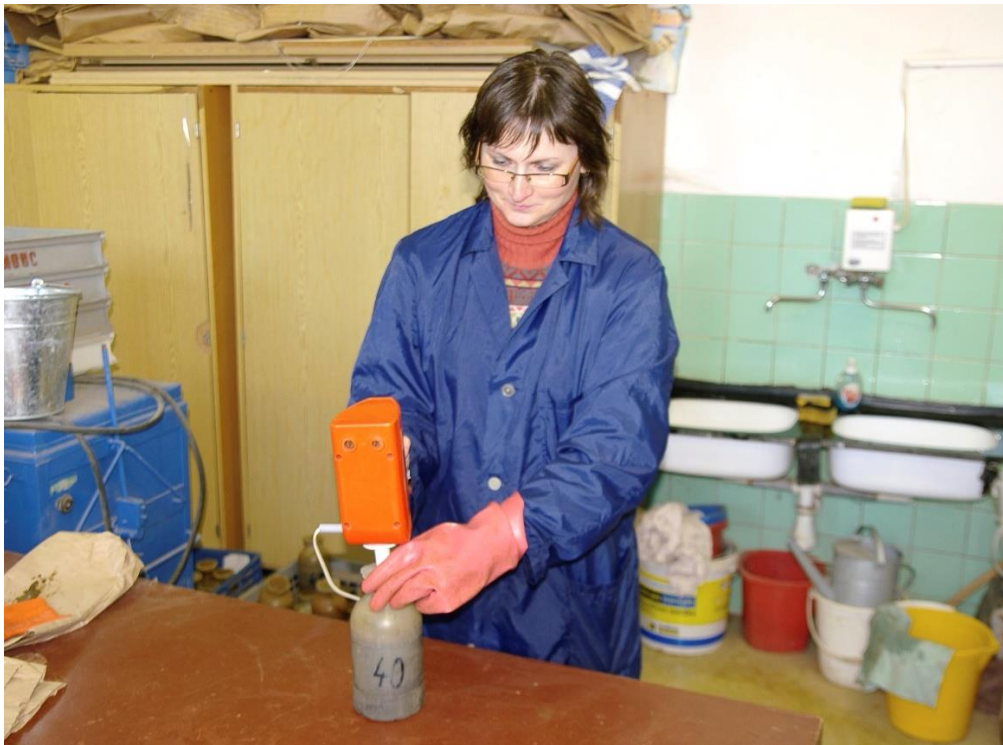
Obr. 3. Homogenizace vzorku tekutého/kapalného hnojiva/ tyčovým mixérem (foto J. Dostál).
