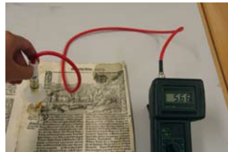
Měření pH před restaurátorským zásahem.
