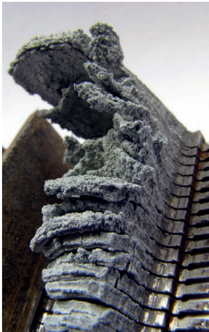
Případ silné koroze olověných kamenů ocelového hřebene; v těchto případech jsou vlivem úbytku materiálu tóny v basové poloze natolik rozladěny, že kvalitní produkce u tohoto nástroje již není možná
