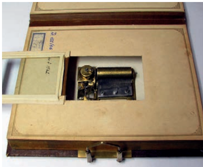
Detail perforovanou deskou ovládaného akustického elementu se zvonkohrou německé firmy Kalliope; přelom 19. a 20. století
