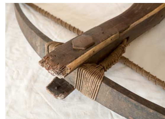
Obr. 111 Lovecká kuše, konec 16. stol., Německo, soukromá sbírka. Hlava lučiště silně degradována napadením dřevné sochy červotočem, degradace materiálu zčásti přechází do kostěných prvků obložení, kovové lučiště na povrchu napadeno korozí a chybně upevněno provazovým úvazem, u něhož chybí železné oko. Soukromá sbírka.
