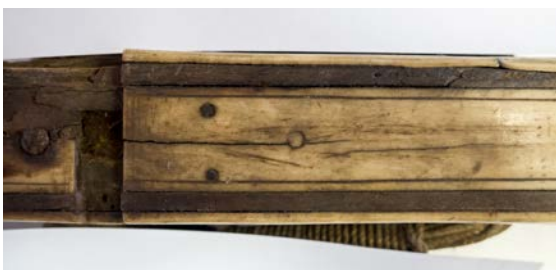
Obr. 114 Kuše, konec 16. stol., Německo, soukromá sbírka. Detail obložení sochy kuše ze slonoviny, na níž jsou patrné známky degradace v podobě prasklin, způsobených rozdílnou dilatací při sesychání dřeva a slonoviny vlivem vlhkosti v klimatu. Ta spolu s prašností v klimatu způsobuje rovněž postupnou povrchovou změnu barevnosti materiálu.
