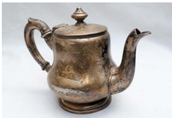
Obr. 106 Stříbrná konvice, 1. ¼ 20. stol., Anglie, soukromá sbírka. Ukázka degradace předmětu povrchovou korozí (tzv. zčernání), způsobenou pokrytím povrchu oxidem stříbrným vlivem vlhkosti a přítomnosti sulfidových či chloridových iontů v klimatu.
