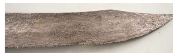
Obr. 91 Lovecký tesák, přelom 17. a 18. stol., Německo, soukromá sbírka. Ukázka devastace povrchu čepelí rzi, jejíž podoba přecházející z důlkové koroze do hlubokých kavern, se objevila po nevhodné aplikaci směsi kyseliny fosforečné, použité pro její odstranění. Směs kyseliny současně způsobila i devastaci struktury hmoty kovu.
