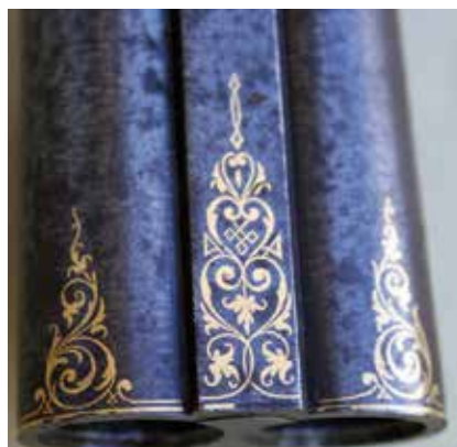
↖ Sulfidová koroze na stříbrném poháru ↑ Tausie na ústí hlavňového svazku
