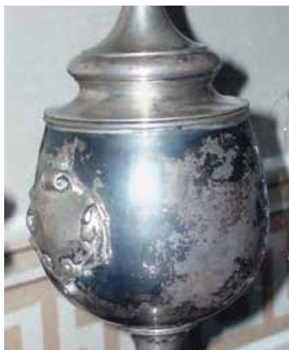
↖ Sulfidová koroze na stříbrném poháru ↑ Tausie na ústí hlavňového svazku
