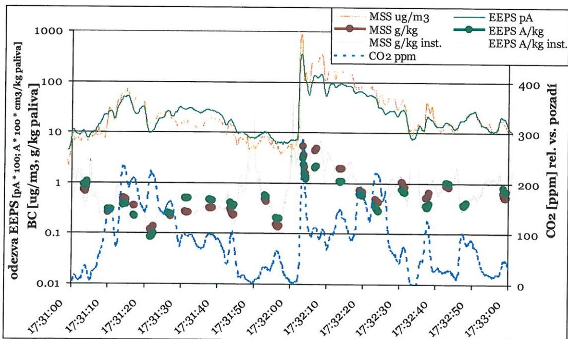
Obr. 2: Naměřené koncentrace CO<sub>2</sub> (s odečtem pozadí, pravá osa, modře), elementárního uhlíku (žlutě, vyjádřen v ug/m<sup>3</sup>) a průměrný proud elektrometru detekovaný EEPS (vyjádřen ve stovkách pA), emisní faktory elementárního uhlíku (g/kg paliva) a proudu EEPS (stovky A \* kg paliva/cm<sup>3</sup>), s tučně zvýrazněnými body výpočtu emisních faktorů pro jednotlivá vozidla.
