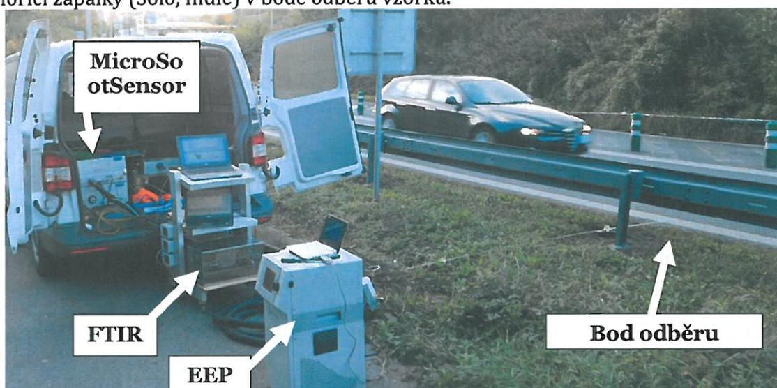
Obr. 1: Měřicí aparatura
