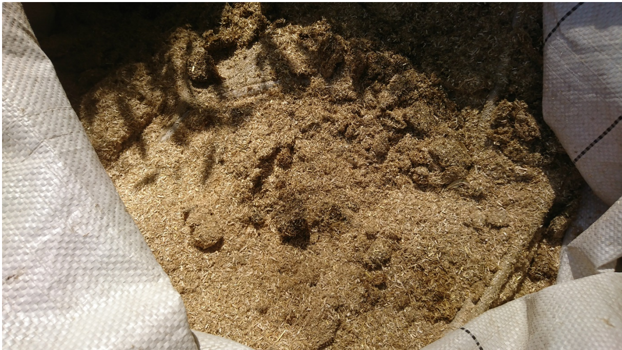
Obr. 3: Drcenou slámu určenou k výrobě slaměných pelet lze použít jako alternativu k dnes již obtížně dostupným obilním plevám
