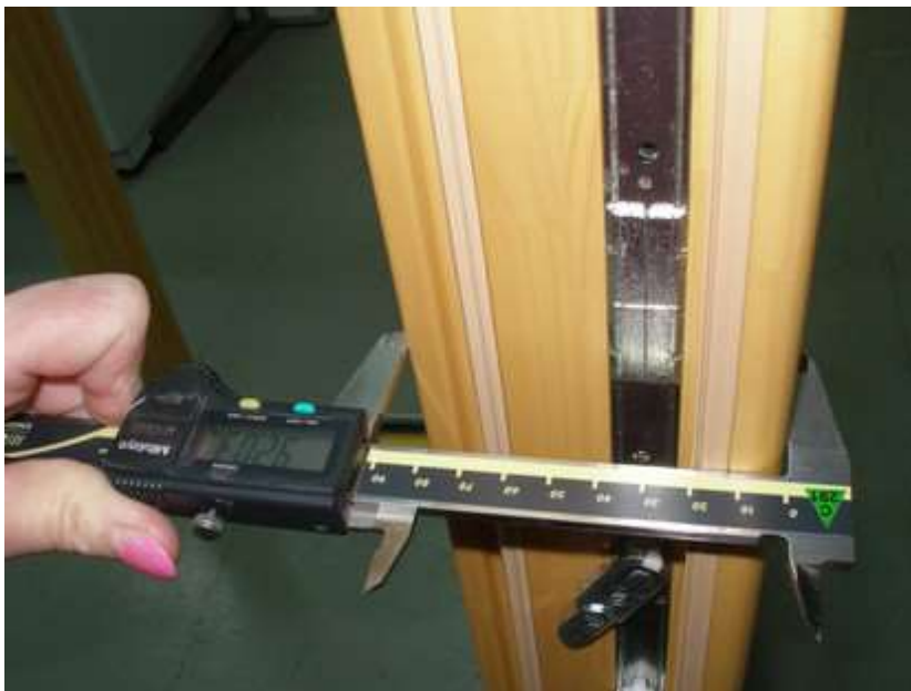
Foto 2: Přesné měření geometrie profilů umožní odhalit i malé výrobní tolerance, které však výrazně ovlivňují průvzdušnost oken.
