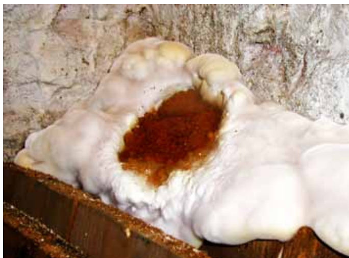
Obr. 1: Typická aktivní dřevomorka domácí
