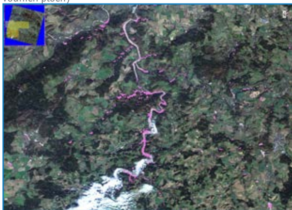
Obr. 53 Příklad výsledku řízené klasifikace (rozsah rozlivu vodních ploch)
