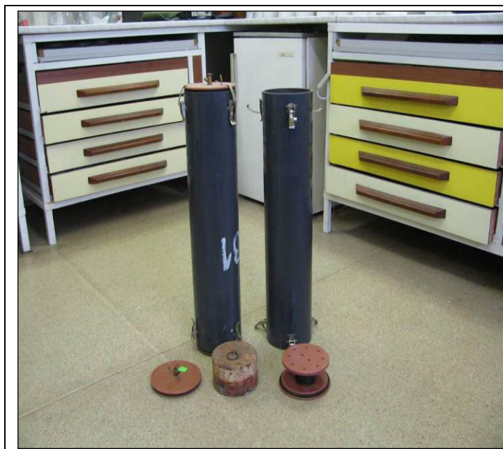
Obr. 1: Minisila o kapacitě cca 5 kg sloužící k laboratornímu testování procesu silážování
