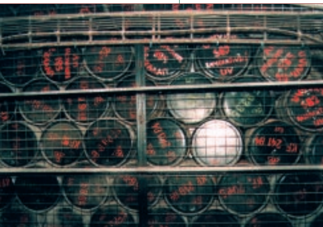
Dvěštitrové sudy v úložišti radioaktivních odpadů Richard
