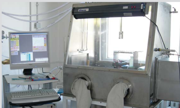
Experimentální zařízení pro studium elektrochemických charakteristik v ÚJV Řež, které tvoří niklový elektrolyzér umístěný v suchém boxu.
