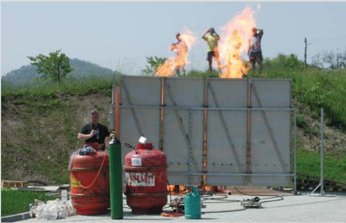
Test pracoviště pro pálicí zkoušky obalových souborů.
