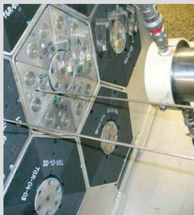
Příprava měření neutronového pole v modelu části vyvíjeného transmutoru s palivem na bázi fluoridových solí, vpravo na snímku je terčová komora neutronového zdroje.
