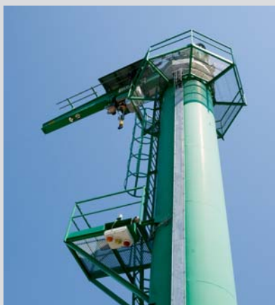
Jeřáb pro pádové zkoušky transportních obalových souborů.
