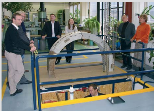
Zahájení experimentu v rámci projektu 6.RP Euroatom TIMODAZ v laboratoři Centra experimentální geotechniky FSv ČVUT Praha. Předmětem výzkumu je vliv dlouhodobého tepelného zatížení ostění na jeho stabilitu.
