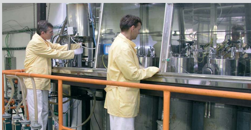
Experimentální linka pro frakční destilaci fluoridů (ÚJV Řež u Prahy). Metoda umožňuje separaci některých komponent vyhořelého jaderného paliva.
