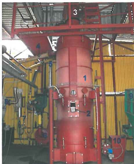
Obr. 6: Souproudý generátor Imbert lokalizovaný v obci Louka
