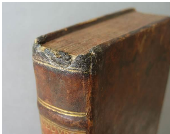
Obr. 38 /Stav pokryvu po restaurování pomocí dvojité AJF typu RK-00 s Klucel G v ethanolu
