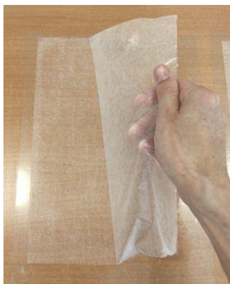
Obr. 9 /Snímání fólie z plastové podložky (šipka znázorňuje směr snímání přířezu fólie)
