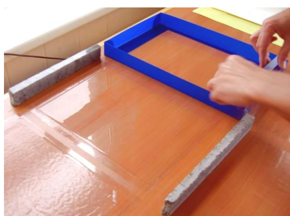
Obr. 14 /Odkrytí rámečku. Patrná nanesená vrstva lepidla na plastové podložce.
