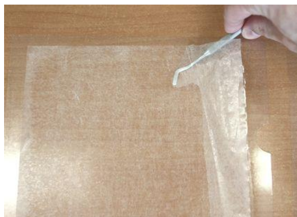
Obr. 8 /Kovovým hladítkem uvolníme fólii na dvou stranách přířezu (pro plynulé sejmutí fólie z plastové podložky)
