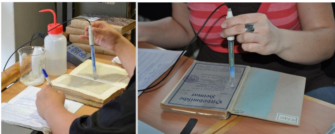
Obr. 1: Stanovení hodnoty pH papíru.
