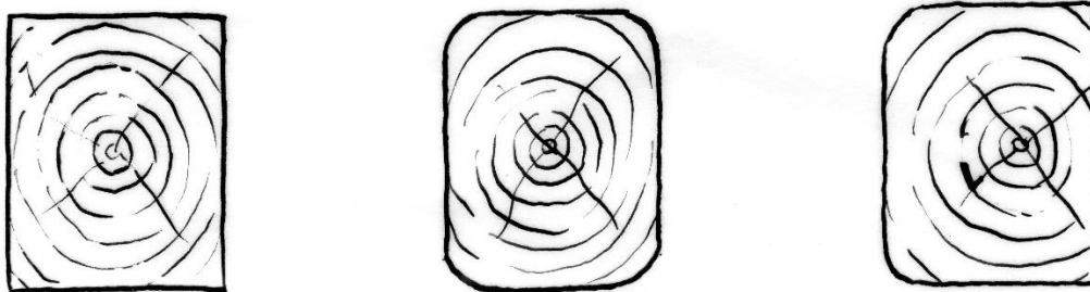
Obr. 25 a) Centrický profil ostře hraněný, b) centrický profil s oblinami, c) excentrický profil s oblinami na jedné straně prvku
