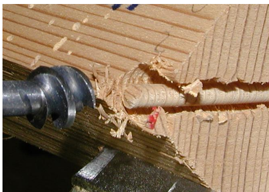
Obr. 14 Detail odběru vzorku válcovitého tvaru
