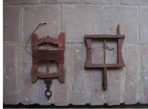
Obr. 72 Pokosník (vlevo), značkovací šňůra s blinkou (vpravo)
