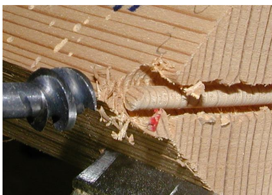
Obr. 14 Detail odběru vzorku válcovitého tvaru
