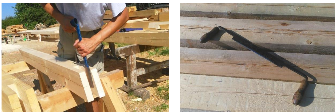
Obr. 70 Dlátovka (vlevo), poříž (vpravo)
