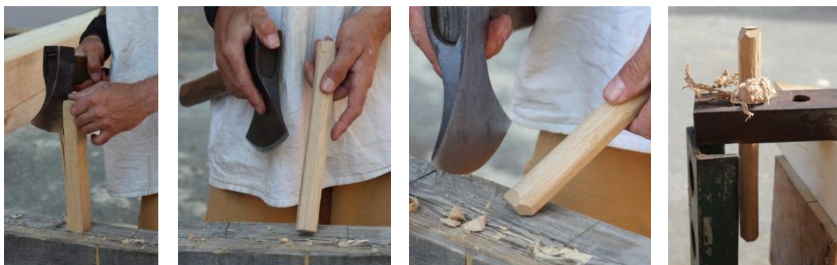
Obr. 28 Postup výroby kolíků
