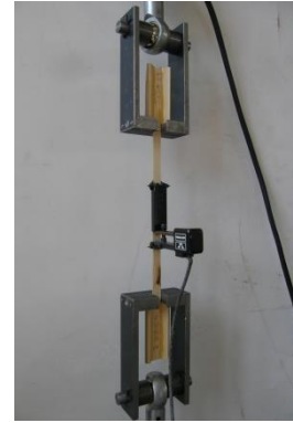
Obr. 17 Tabová zkouška trojúhelníkové lišty
