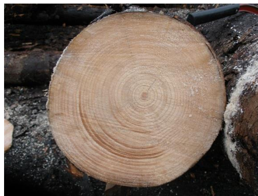
Obr. 74 Lícování (vlevo), tlakové dřevo smrku (vpravo)
