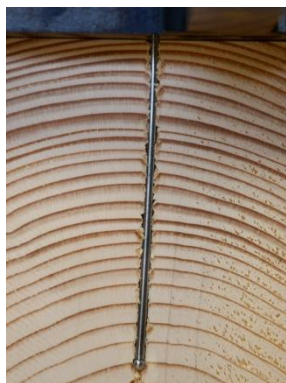
Obr. 12 Detail průniku trnu materiálem
