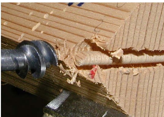
Obr. 14 Detail odběru vzorku válcovitého tvaru
