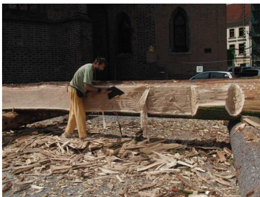
Obr. 74 Lícování (vlevo), tlakové dřevo smrku (vpravo)
