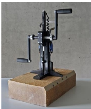
Obr. 11 Přístroj pro měření mechanického odporu dřeva při zatláčování trnu
