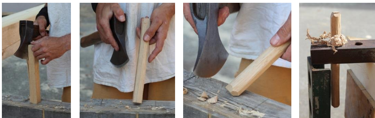
Obr. 28 Postup výroby kolíků
