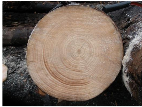
Obr. 42 a) Lícování, b) tlakové dřevo smrku
