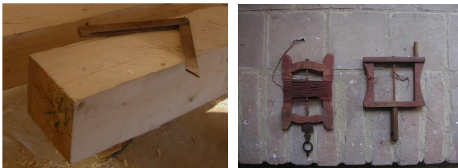
Obr. 40 a) Pokosník, b) značkovací šňůra s hlinkou
