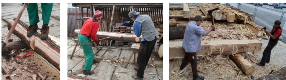
Obr. 41 Vrubování (vlevo, uprostřed) [16], hrubování (vpravo)
