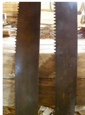
Obr. 39 a) Tažný plát pily pro podélné řezání, b) tažný plát pily pro příčné řezání
