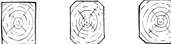
Obr. 12 a) Centrický profil ostře hraněný, b) centrický profil s oblinami, c) excentrický profil s oblinami na jedné straně prku
