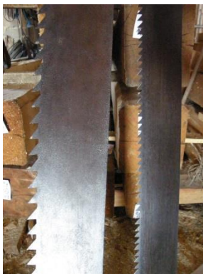
Obr. 39 a) Tažný plát pily pro podélné řezání, b) tažný plát pily pro příčné řezání
