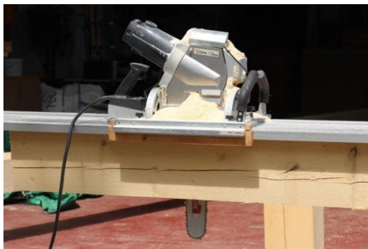
Obr. 22 Řezání podélného plátu pomocí tesařské řetězové pily
