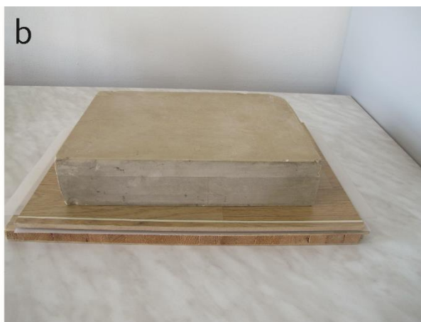
Obr. 15-8 a, b Sušení podlepeného identifikačního štítku mezi netkanou textilií a filtračními papíry
