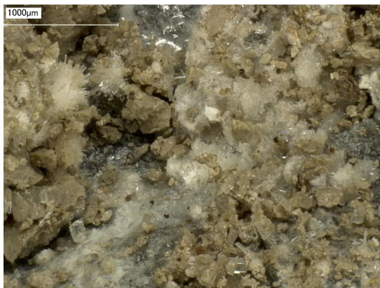
Obr. 4-4 Síranový gel (vlevo nahoře) na povrchu kosterního pozůstatku želvy. Zbytek vzorku pokrývají různé krystalové formy sádrovce. Miocén, lokalita Ahníkov II. Snímek z 3D mikroskopu.
