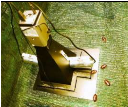
Obr. 11: a) prototyp zařízení pro detekci lezoucího hmyzu; b) vývojový vzorek senzoru polétavého hmyzu
