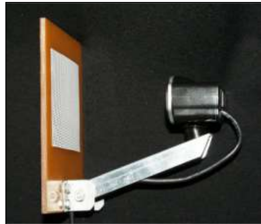
Obr. 11: a) prototyp zařízení pro detekci lezoucího hmyzu; b) vývojový vzorek senzoru polétavého hmyzu
