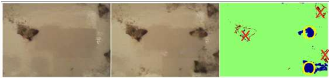
Obr. 7: Dva snímky pořízené s časovým odstupem (senzor polétavého hmyzu s grafickým výstupem obrazové analýzy; identifikace nově zachycených jedinců)
