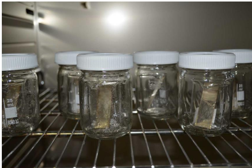
Obr. 12 – Kondenzace vody uvnitř testovacích nádob (100 % RH)
