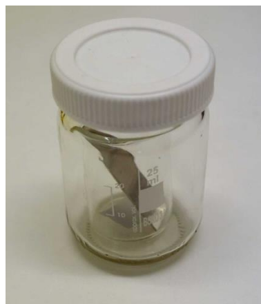
Obr. 10 – Nádoba se vzorkem a testovým materiálem připravená k umístění do sušárny
