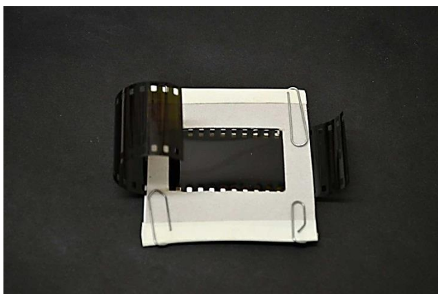
Obr. 23 Filmový negativ v papírové paspartě umístěný nad deskou (zjednodušená expozice)
