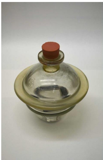
Obr. 27 Exsikátor použitý pro vyvolávání
