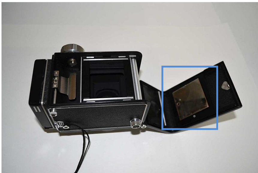
Obr. 26 Umístění zcitlivěné daguerrotypické desky ve fotoaparátu Flexaret Standard z roku 1967
