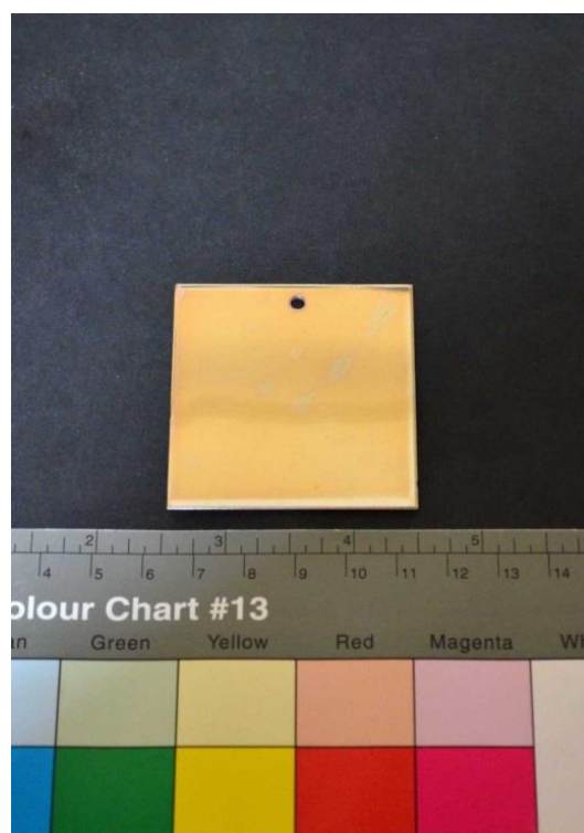
Obr. 16 Barevné změny na povrchu desky během zcitlivění (první cyklus)
