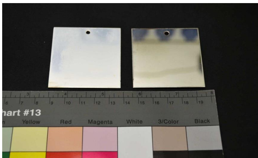
Obr. 10 Srovnání povrchu po stříbření (vlevo) a po leštění (vpravo)
