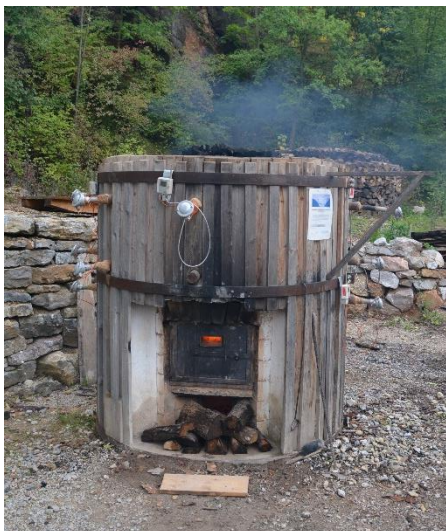
Obr. 4: Experimentální pec v Solvayových lomech. Při jednorázovém výpalu lze získat 500 kg páleného kusového vápna. Graf vlevo ukazuje průběh teploty během výpalu ve středu pece nad klenbou. Za přibližně 15 h bylo dosaženo 900 °C a výpal trval dalších 15 hodin.
