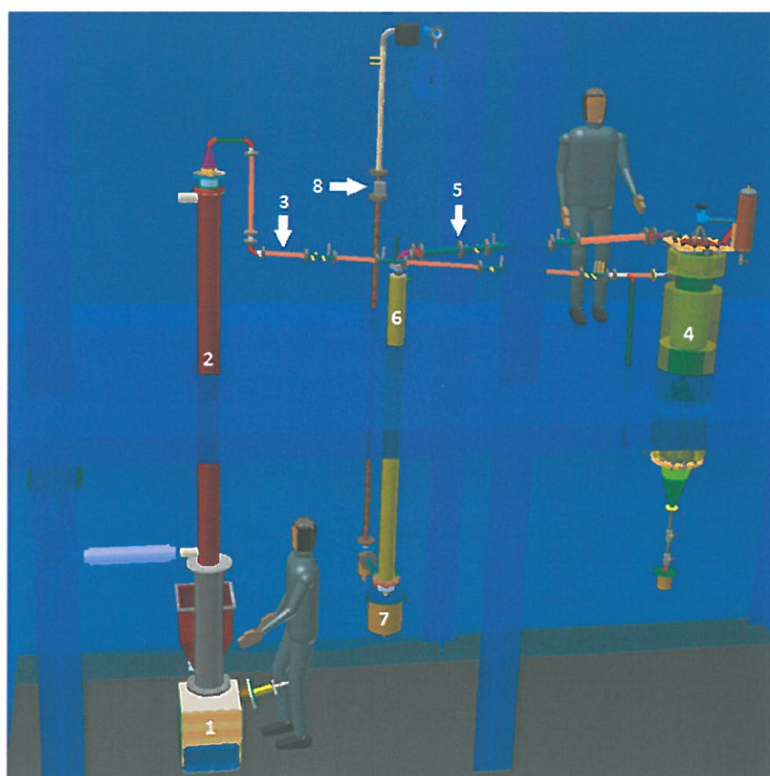
Obr. 1 – Pohled na aparaturu v 3D modelu. 1 – retortový hořák, 2 – souprůdný vzduchový chladič, 3 – spalínovod 1, 4 – filtrační reaktor, 5 – spalínovod 2, 6 – protiproudý vodní chladič, 7 – kondenzační nádoba, 8 – průtokoměr
