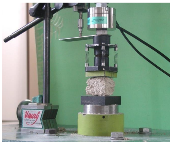
Obr. 13. Zkušební těleso před začátkem zkoušky pevnosti v tlaku
