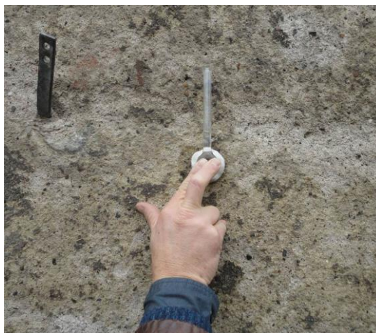
Obr. 8. Průběh měření nasákavosti pomocí Karstenovy trubice
