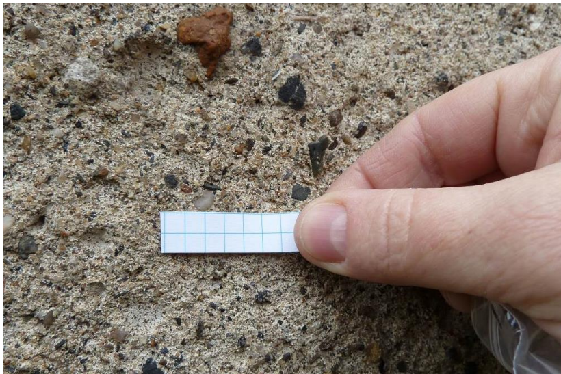
Obr. 4. Aplikace adhezního proužku během in-situ měření na Karlštejně
