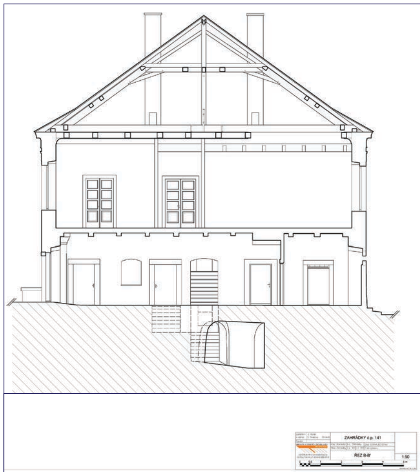
Obr. 22. Kombinace stavební a geodetické metody při zaměření domu č. p. 141 v Zahrádkách u České Lípy v případě tvorby řezů. Zaměření a kresba David Skalický, Jan Horák 02/2014.
