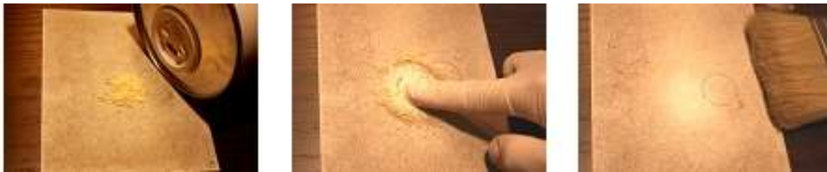
Obr. 2: Ukázka mechanického čištění pomocí práškového materiálu.
