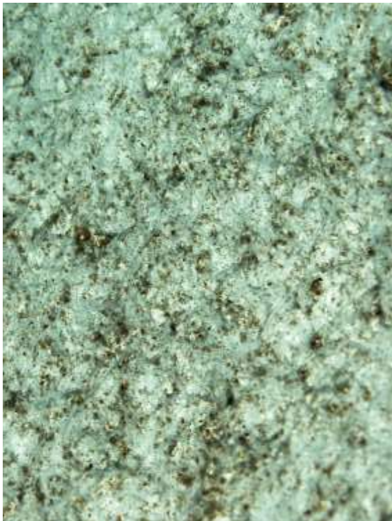
Obr. 7: Vzorek papíru po aplikaci prachových částic (před čištěním).
