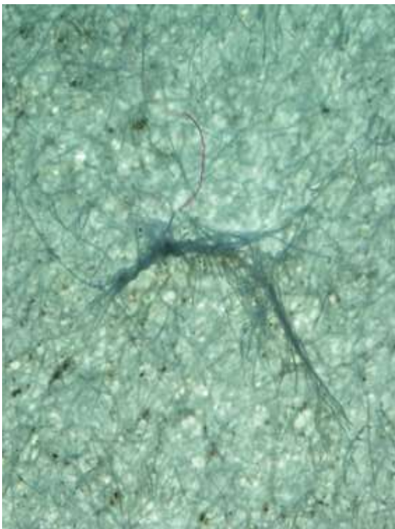
Obr. 9: Vzorek papíru po čištění pomocí pevného bloku na bázi faktisu (nevhodná metoda – poškození).
