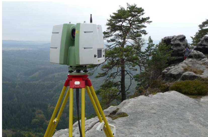
Pohled z bodu 4003 se skenerem na 4004 s ručně fixovaným terčem Leica 6" circular target na teleskopické výtyčce GLS13, foto Z. Vařilová
