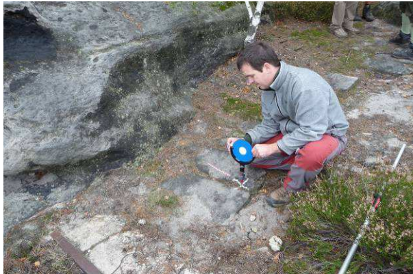
Orientační terč Leica 6" circular target na mini-výtyčce GP PROF1 ručně fixovaný na dočasném bodu stanoviška 4002, který odpovídá bodu sítě GPR Osa X[12] Y[0], foto Z. Vařilová
