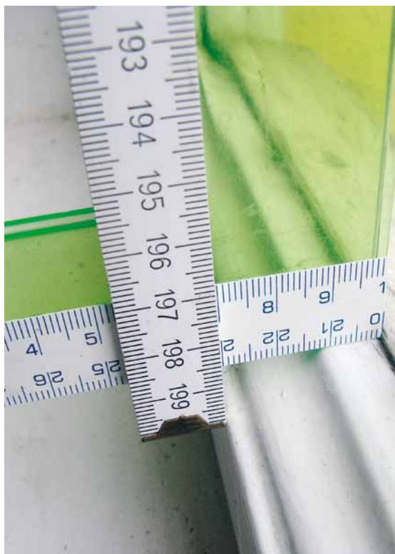
Obr. 22: Ukázka oměřování profilace pomocí přiložené pravouhelného trojúhelníku (foto A. Horková, 2014).
