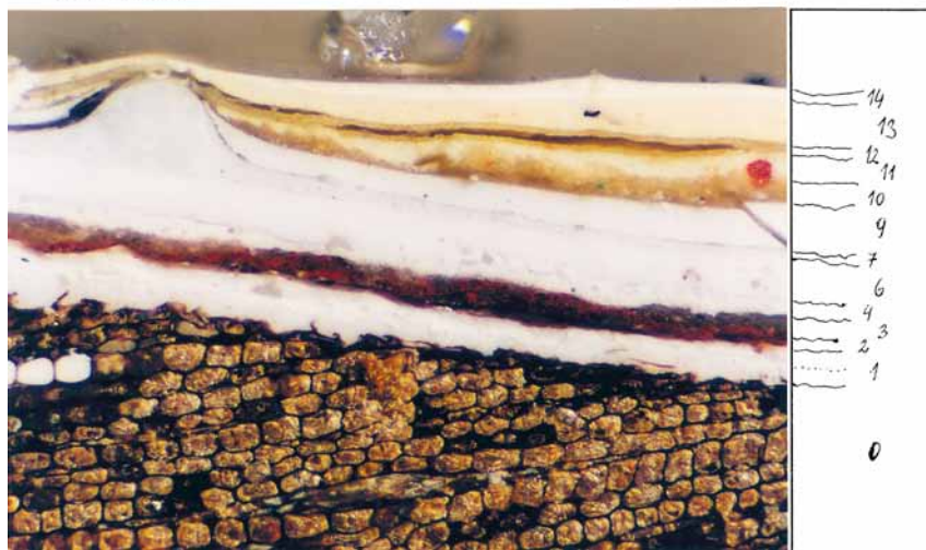
Obr. 37: Ukázka mikroskopického průřezu souvrství starších nátěrů (foto P. Mařík).
