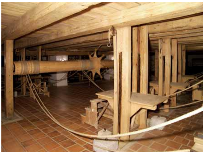
Český Krumlov, zámecké divadlo. Jevištní mašinerie v suterénu pod jevištěm.
