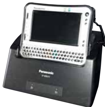
Obr. 4. PC mobilní lokalizátor exponátů zabezpečených radio čidly.
