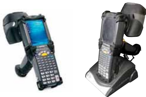
Obr. 1. PC mobilní čtečka pro programování a načítání RFID čipů (identifikačních a bezpečnostních prvků). (Všechny fotografie Karel Bobek)
