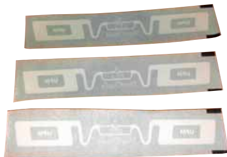
Obr. 2. RFID tagy – programovatelné čipy pro identifikaci a zabezpečení předmětů kulturního mobiliáře.
