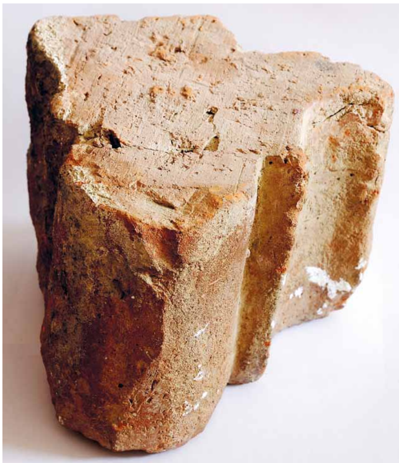
Celkový pohled na tvarovku s patrnými stopami seříznutí materiálu na zachované ložné ploše v horní části snímku.
