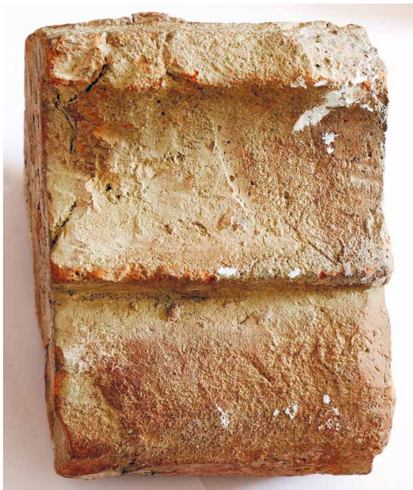
Bok profilu s patrnými stopami výrobních nástrojů.
