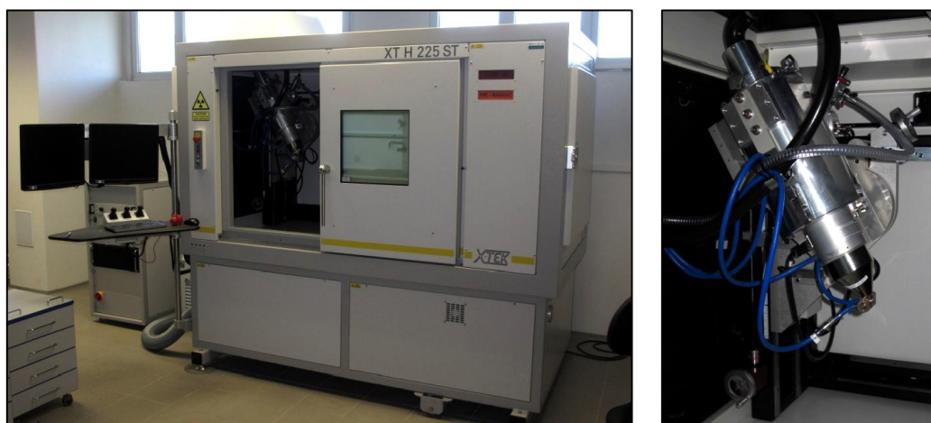
Obr. 4 RTG. CT tomograf XT H 225 ST a reflexní mikrofokální zdroj RTG záření 225 kV
