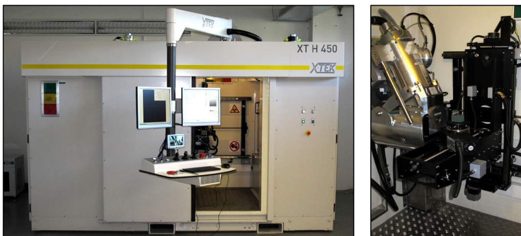
Obr. 3 RTG. CT tomograf XT H 450 2D/3D a reflexní mikrofokální zdroj RTG záření 450 kV
