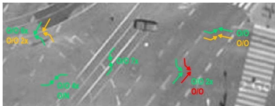
Obr. 3 Příklad části konfliktního diagramu na podkladu ortofotomapy
